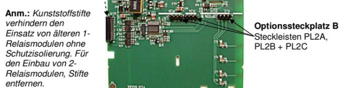
Anm.: Kunststoffstifte verhindern den Einsatz von älteren 1-Relaismodulen ohne Schutzisolierung. Für den Einbau von 2-Relaismodulen, Stifte entfernen.
