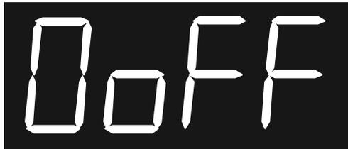
**Ausgang EIN/AUS schaltbar:** Bei Betätigung der A/M-Taste verläßt der Regler den Regelprozeß. Die Regelausgänge werden auf 0 geschaltet. Nochmalige Betätigung der A/M-Taste schaltet den Regelprozeß wieder ein.
