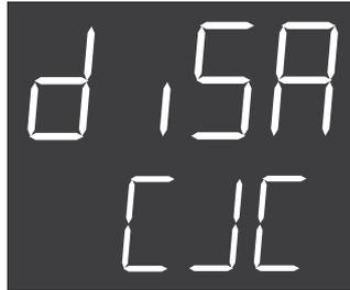
wenn die Vergleichsstellen-Kompensation gesperrt ist. Die Vergleichsstellen-Kompensation kann nun ermöglicht oder gesperrt werden, wie zuvor beschrieben. Die Grundeinstellung ist "ermöglicht". Dieser Parameter erscheint nur in der Konfigurationsanzeige, wenn die Eingangsart Thermoelement gewählt wurde. Ist die Vergleichsstellen-Kompensation gesperrt, erscheint folgende Anzeige im Normalbetrieb:
