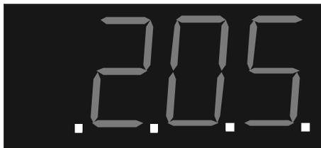
(d. h. alle Dezimalpunkte sind sichtbar), so sind die Parameter auf Grundeinstellung zurückgesetzt. Die Dezimalpunktewerdengelöscht, indem ein Parametrier-Parameter ver stellt wird (siehe unten). **Es wird empfohlen, alle Parameter im Konfigurationsbetriebeinzustellen, bevor Einstellungen im Parametrierbetrieb verändert werden.**
