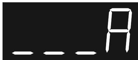
Ist das Soft Start Programm aktiviert, zeigt die Anzeige der Stromaufnahme im unteren Display:
