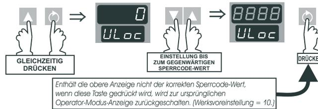
Um in den Setup-Modus zu gelangen, den Controller in den Betriebsmodus mit normaler Anzeige bringen, dann:
