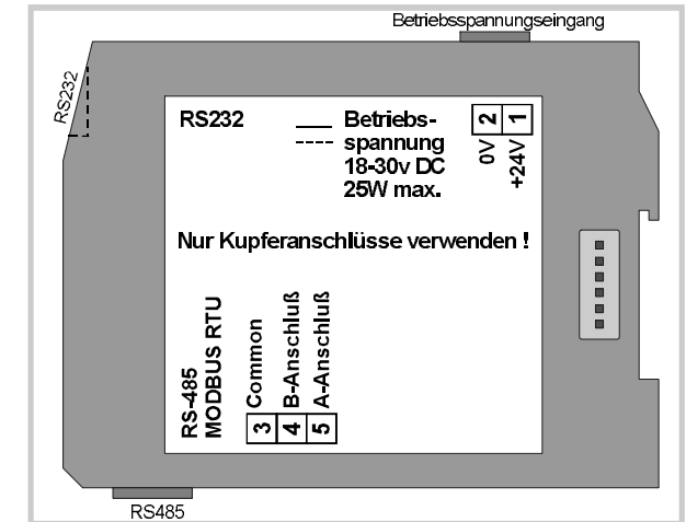
Abb.: 4 Anschlüsse des Bus-Kommunikationsmoduls
