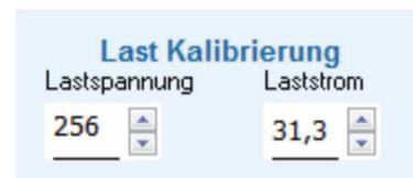
**! HINWEIS!** Die Last Kalibrierungseinstellungen, Lastspannung und Laststrom definieren 100% Leistung für die Last.
