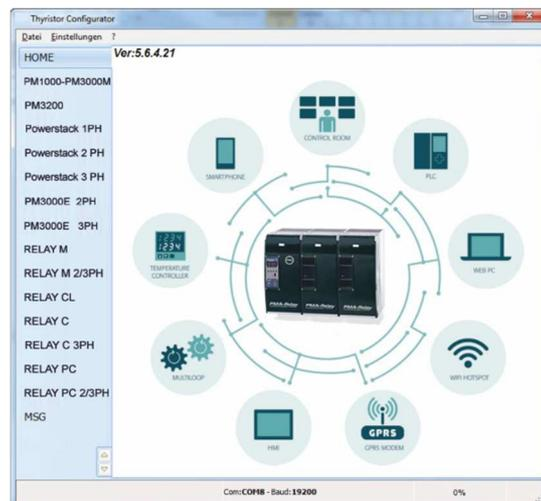
**Relay C** → öffnet die Ansichten "Simple" und "Test" für einen einphasigen Leistungssteller
