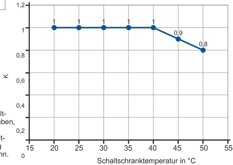
Sollten Sie höhere Schaltschranktemperaturen haben, kontaktieren Sie den Hersteller, damit eine entsprechende Berechnung durchgeführt werden kann.
