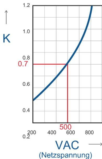
\*  $I^2T$  wird für den K-Wert in Funktion von VAC bei 500 V multipliziert.
