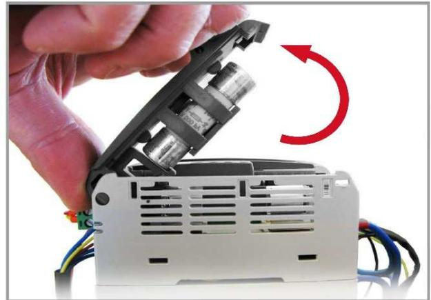
1. Öffnen Sie den Sicherungshalter, indem Sie an der Frontabdeckung ziehen
