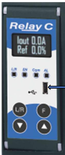
Um das Gerät am PC anzuschließen, ist das Micro USB 2.0 Modbus RTU-Kabel zu verwenden.
