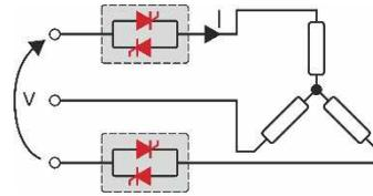
**Dreieck-Schaltung mit ohmscher Last (Ansteuerung über zwei Phasen mit einem PMA-Relay C-2PH)**
