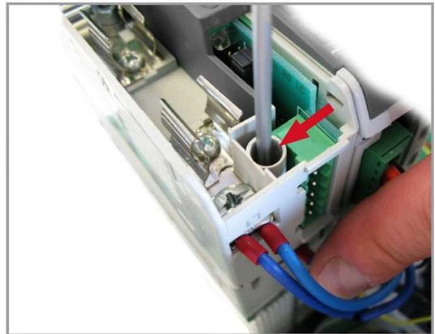
2. Verbinden Sie das Kabel mit L1 (L2, L3)
