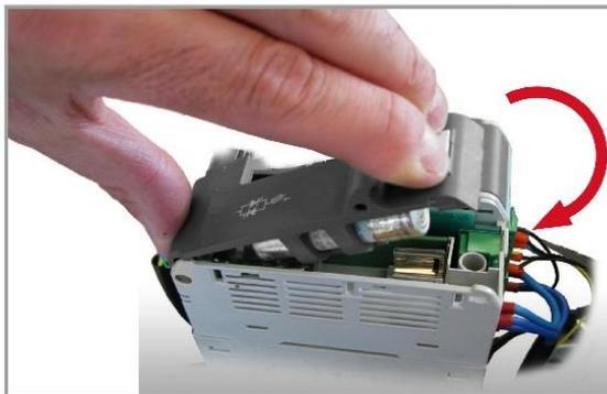
4. Mit etwas Druck, können Sie die Abdeckung schließen.
