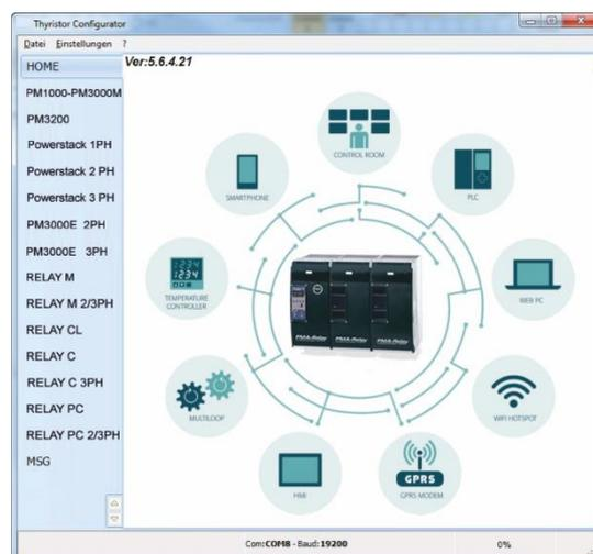
**Relay C** → öffnet die Ansichten "Simple" und "Test" für einen einphasigen Leistungssteller
