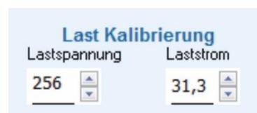
**HINWEIS!** Die Last Kalibrierungseinstellungen, Lastspannung und Laststrom definieren 100% Leistung für die Last.
