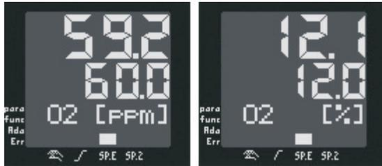
In der unteren Zeile wird die momentane Messeinheit angezeigt. Bei einer Sollwertänderung über die Tasten ▲ oder ▼ wird die Einheit des Sollwertes und der anderen Parameter angezeigt.
