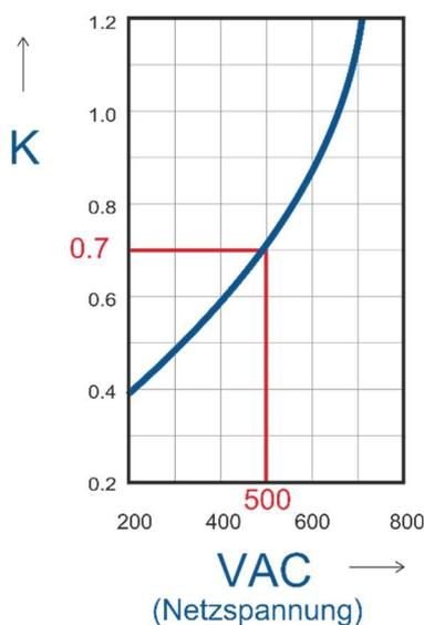
\*  $I^2t$  wird für den K-Wert in Funktion von VAC bei 500 V multipliziert.
