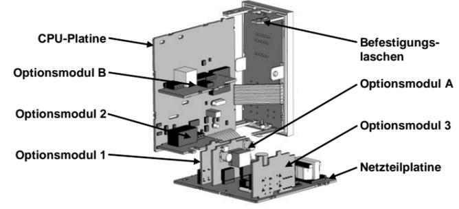
Um Zugang zu den Modulen 1, A oder B zu erhalten, die Netzteil- und CPU-Platinen durch Anheben der oberen und dann der unteren Montagelasche lösen. Platinen vorsichtig voneinander trennen.
