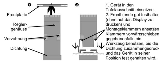
**ACHTUNG:** Für einen wirksamen IP66-Schutz gegen Staub und Feuchtigkeit ist sicherzustellen, dass die Dichtung gut gegen die Montageplatte gedrückt wird, wobei die 4 Federzungen in dieselbe Rastnut greifen müssen.
